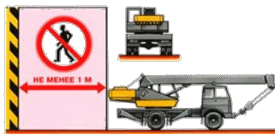
Рис. 20. Схема установки крана вблизи препятствий
